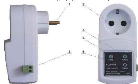
Рис.1. - Внешний вид реле 1 — вилка для включения реле в сеть 220 В; 2 — розетка для включения насоса в реле; 3 — разъем для подключения датчика уровня; 4 — светодиод для индикации наличия напряжения питания; 5 — светодиод для индикации работы насоса и состояния реле; 6 — кнопка «сброс».
